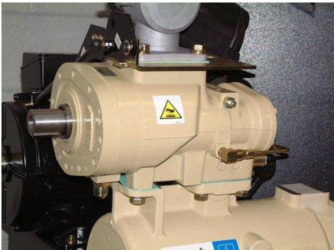
Los rotores se fabrican en acero fundido AISI-C-1141.
